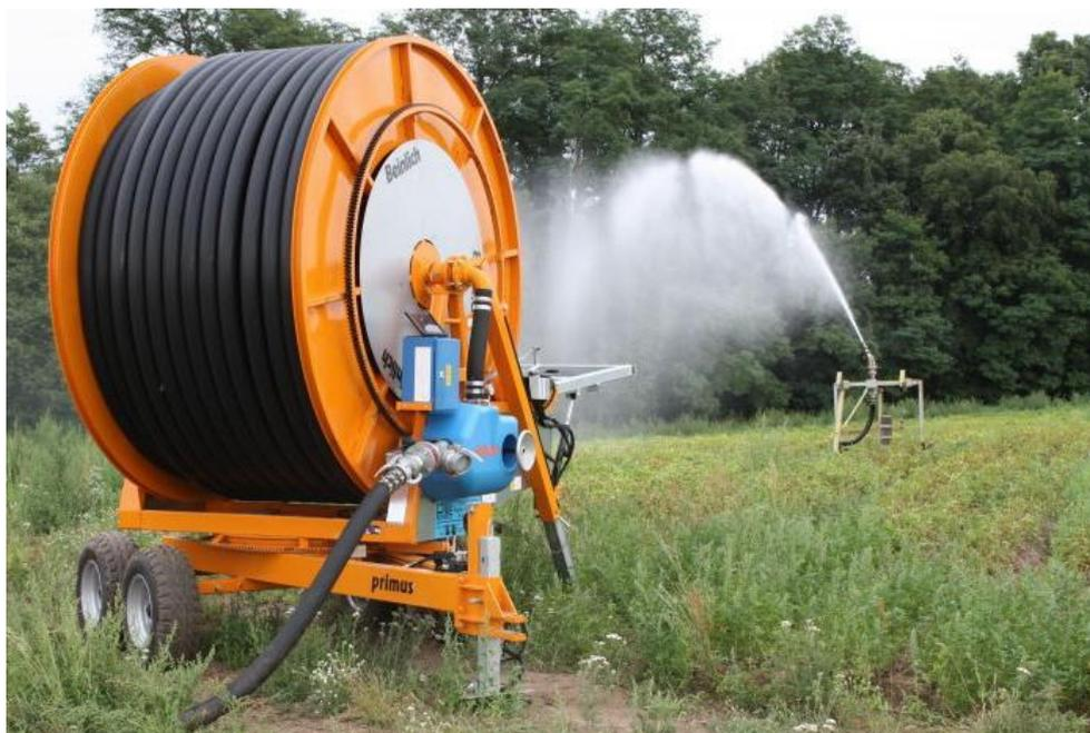
Рисунок 5. Барабанная дождевальная машина Weinlich.
