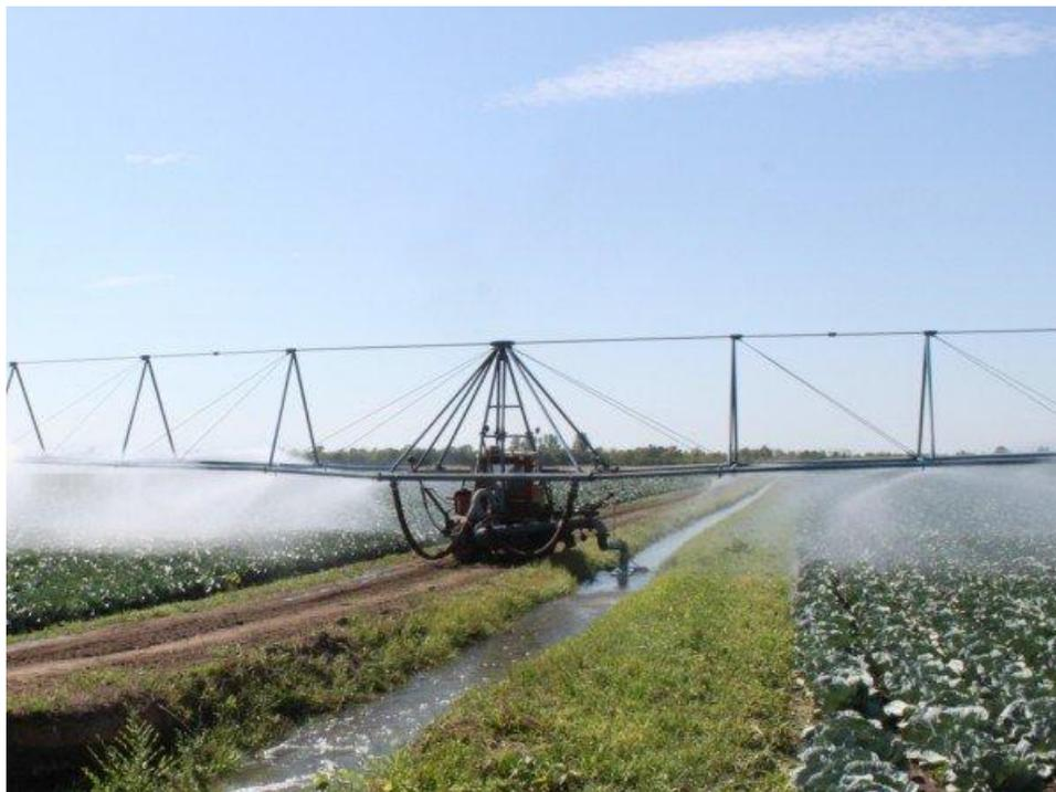
Рисунок 4. Двухконсольный дождевальный агрегат ДДА-100.
