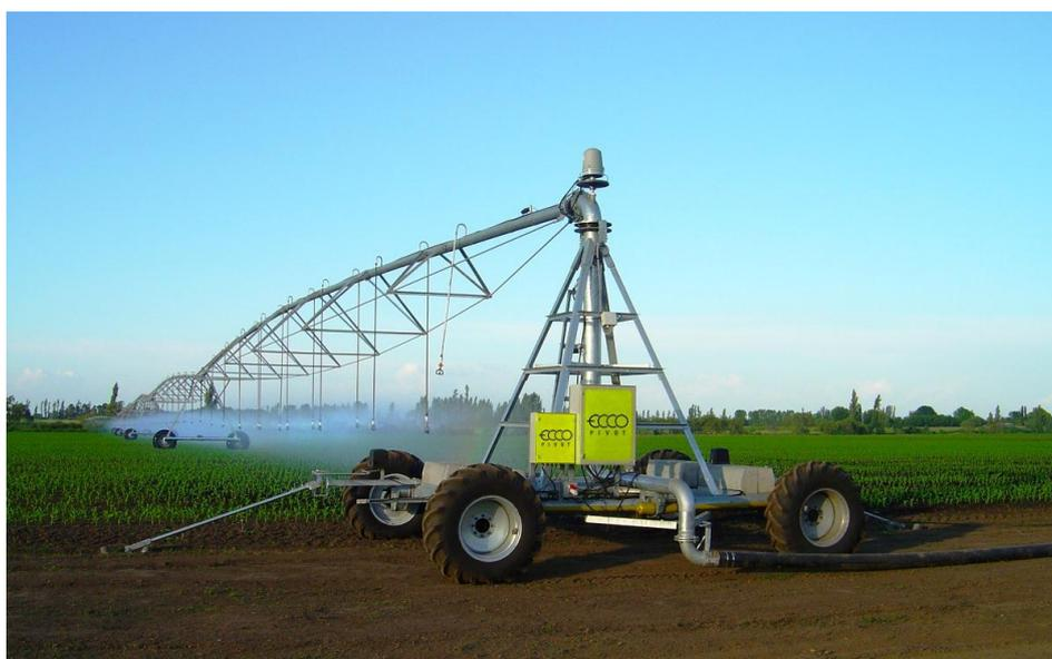
Рисунок 3. Многоопорная дождевальная установка ECCO PIVOT.
