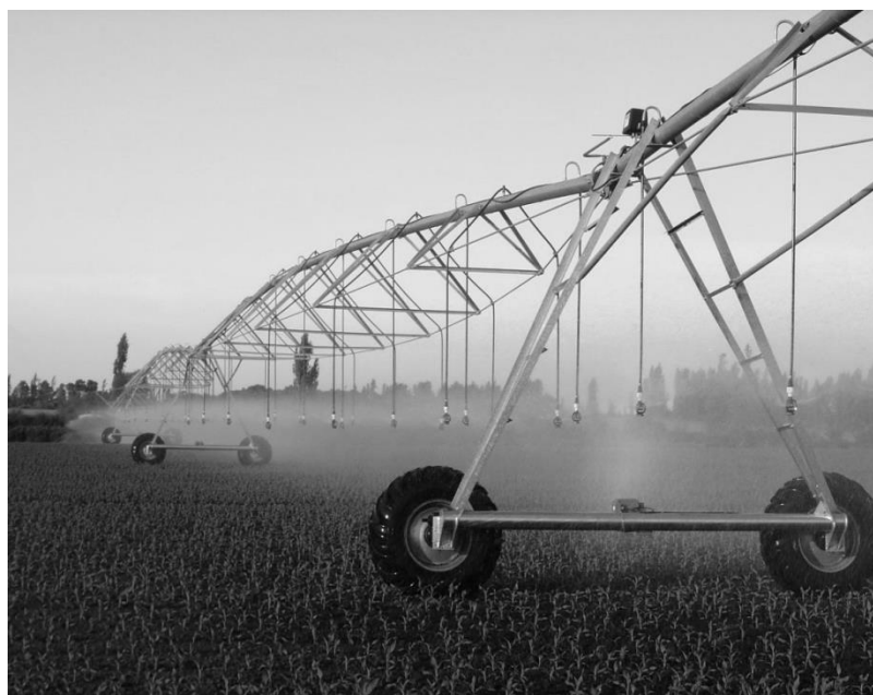
Рисунок 1. Многоопорная дождевальная установка с оросительными насадками веерного типа.
