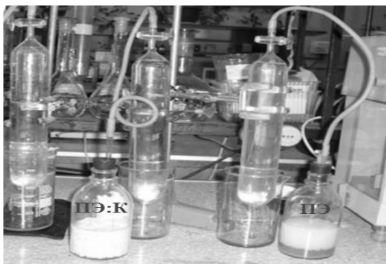
Рисисунок 2. Определение газовыделения при биодеструкции экокомпозигов в анаэробных условиях (образец сравнения – чистый ПЭ, на фото справа)
