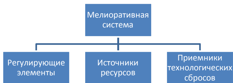
Рисунок 1. Элементы, входящие в состав мелиоративной системы
