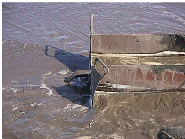
Рисунок 3. Измерение расходов воды и твердого стока с помощью водослива
