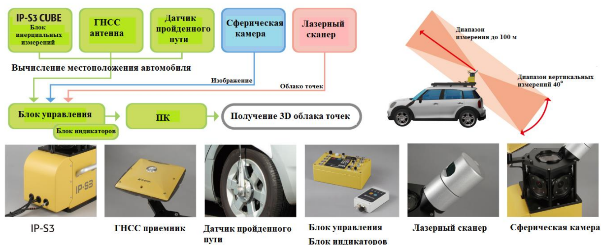
Рисунок 5. Структура мобильной лазерной сканирующей системы
