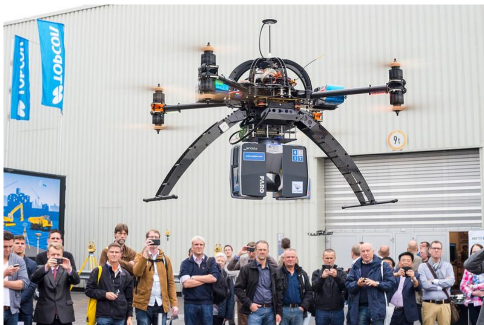
Рисунок 3. Сканирование с БПЛА
