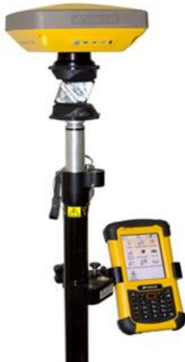
Рисунок 1. Веха с установленной на ней круговой АТР1 призмой с ГНСС приемником Nireg SR и полевым контроллером технологии «Гибрид» компании Topcon
