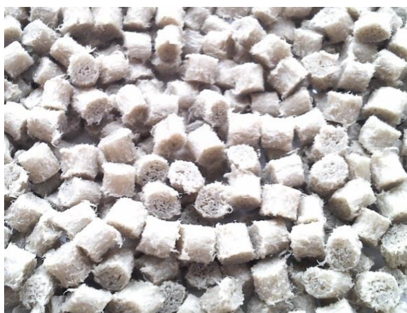
Рисунок 1. Гранулы композитного материала на основе полиэтилена и отработанной микроцеллюлозы (соотношение ПЭ : МЦо = 80 : 20 мас.%)
