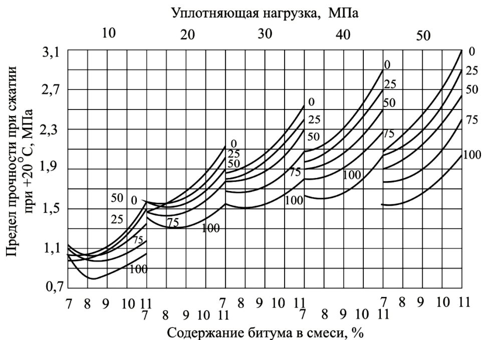
Рисунок 4. Зависимость предела прочности при сжатии от уплотняющей нагрузки, содержания битума марки БНД 90/130 и количества циклов замораживания-оттаивания асфальтобетона из гранулированного доменного шлака НЛМЗ при температуре 20 °С. Цифры на кривых – количество циклов замораживания-оттаивания
