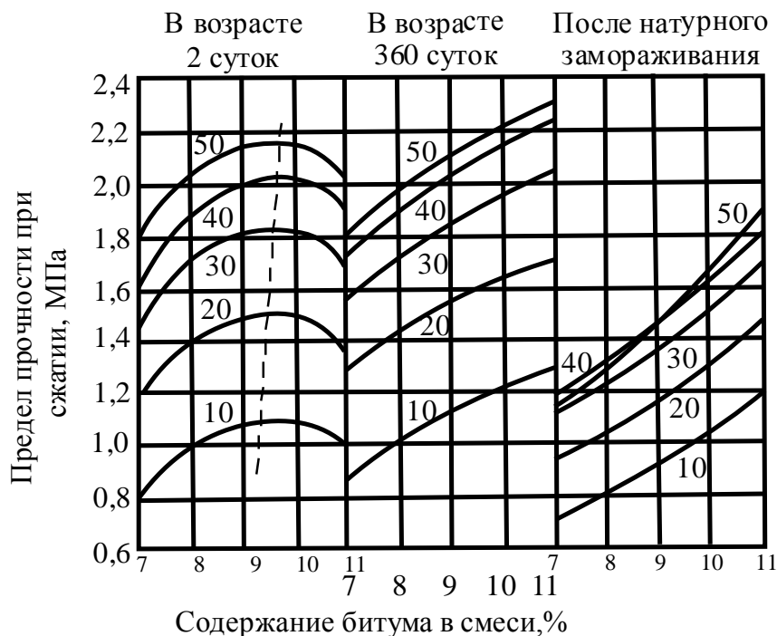
Рисунок 2. Изменение предела прочности при сжатии при температуре 20 °С асфальтобетона из гранулированного шлака в зависимости от уплотняющей нагрузки и содержания битума марки БНД 90/130. Цифры на кривых – уплотняющая нагрузка, МПа
