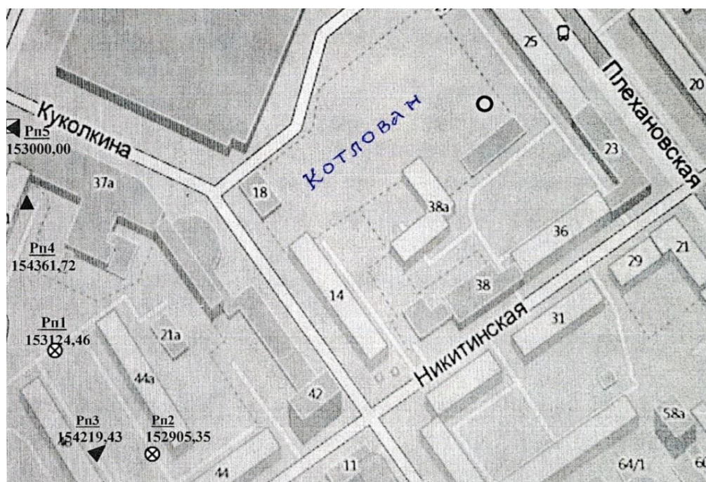
Рисунок. Схема размещения знаков опорной геодезической сети
