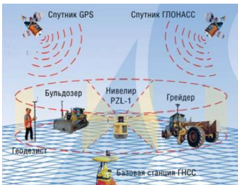
Рисунок 1. Работа 3D системы нивелирования на основе спутниковых сигналов
