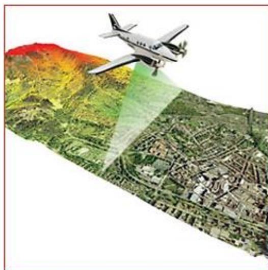
Рисунок 4. Воздушное лазерное сканирование
