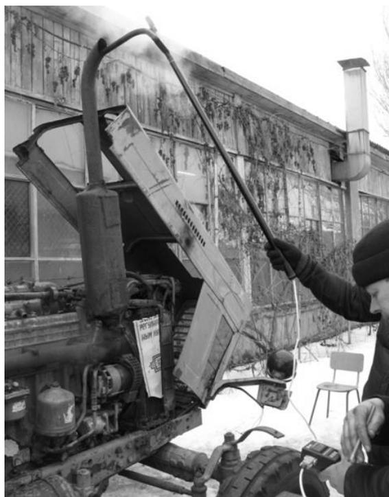
Рисунок 1. Экспериментальные исследования по замерам токсичности отработанных газов прибором МЕТА-01 МП 0.1 ГТН ЛТК;
