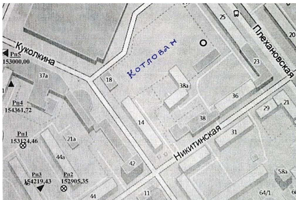
Рисунок. Схема размещения знаков опорной геодезической сети
