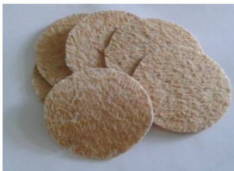
Рисунок 2. Композитная биоагрузка состава «ПЭ:МЦ»
