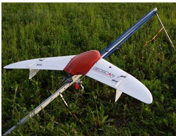
Рисунок 2. БПЛА Геоскан 201
