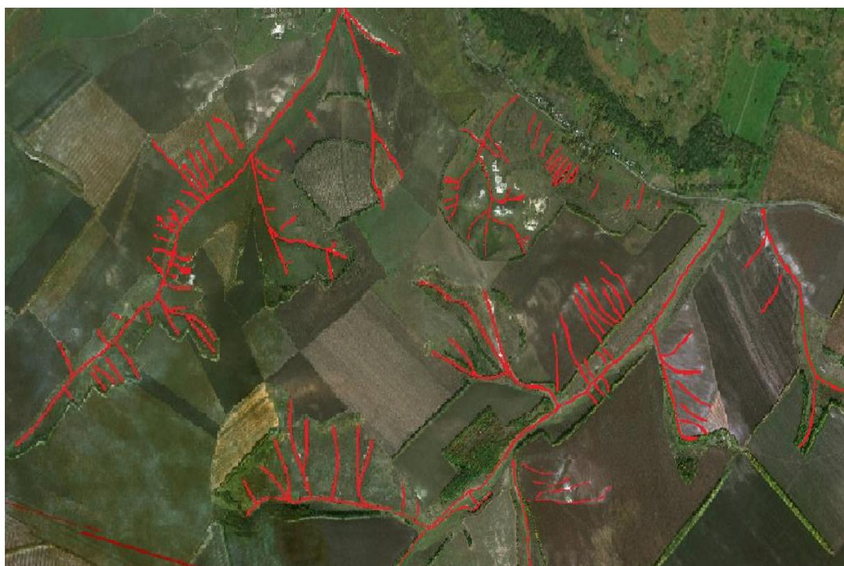
Рисунок 3. Изображение длины и густоты овражно-балочной сети на космическом
