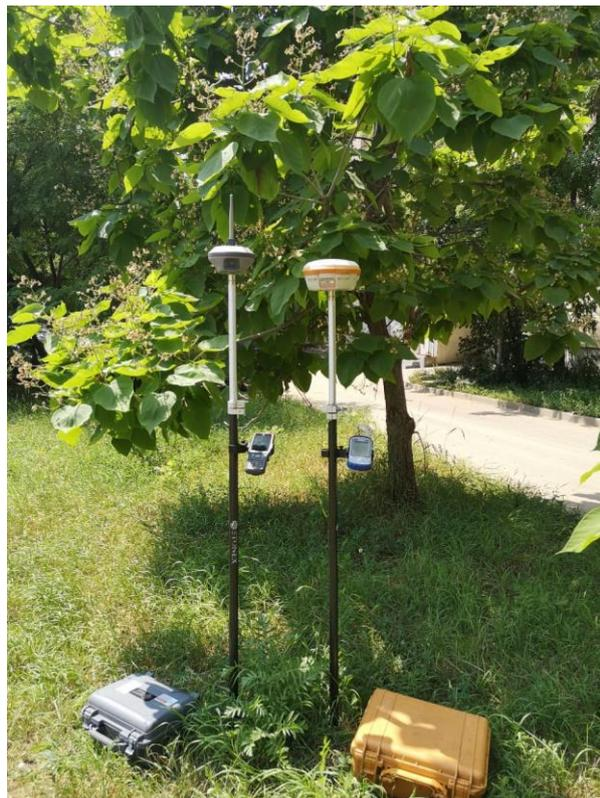
Рисунок 2. Демонстрация современного геодезического оборудования и принципа работы приемника EFT M4 GNSS и EFT M1 GNSS
