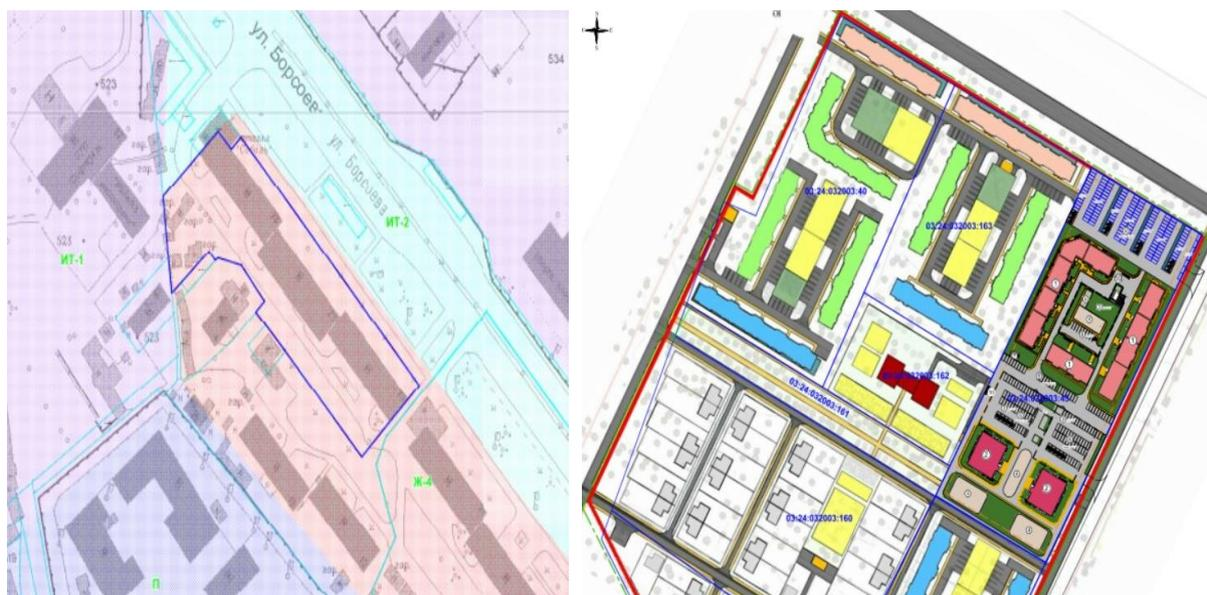
Рисунок 6. Подготовка ПМТ в графической программе (MapInfo и AutoCad)
