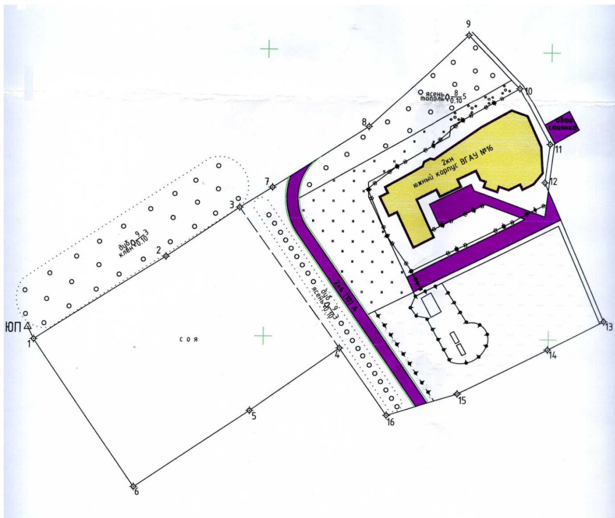
Рисунок 1. Топографический план М 1:1000, составленный по результатам геодезических измерений 1 курс, бр. №1, 2021 г.
